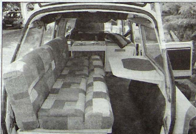
L'arrière permet de vivre en autonomie complète : dinette (gaz et frigo), lit, table... De nombreux rangements sont prévus pour le matériel de prise de vues et les pièces détachées.
